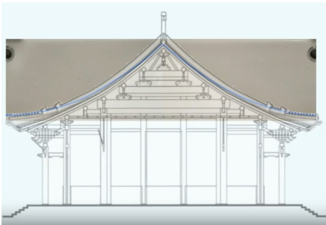
图 9：古建筑屋檐利用最速降线最快排水
